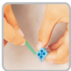
Spelare il cavo di 12-13 mm Wire Stripping length 12-13mm
