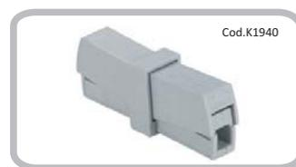
I Morsetti per l'illuminazione sono connettori per cavi rigidi e flessibili utilizzabili per sezioni fino a 2,5mm<sup>2</sup>. Non necessitano di cacciavite. Connessione Push-wire. Inserire il cavo rigido (lato installazione) nel foro circolare e il cavo flessibile (lato illuminazione) nel foro quadrato.
