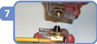
**Fig. 3:** Una volta percepita la rottura alla base del canotto tirare verso l'esterno la pinza in modo tale da sfilare il canotto dal grano senza compromettere il fissaggio dei cavi installati.
